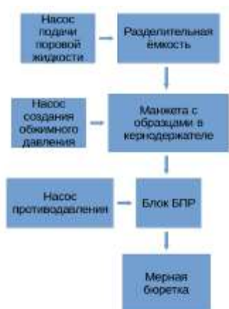
Рис. 5. Блок схема гидравлической части установки
