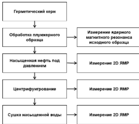
Рисунок 1 Экспериментальный поток с многоступенчатым ядерным магнитным резонансом образцов плунжера с замкнутым керном
