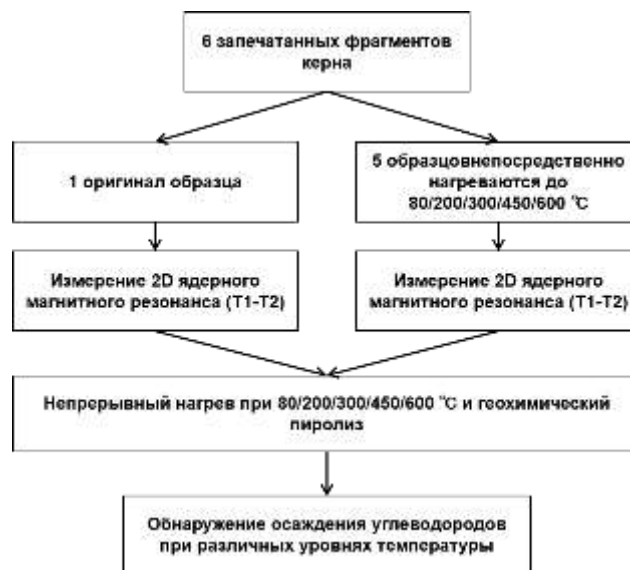
Рисунок 2 Экспериментальный процесс многоступенчатого пиролиза при ядерно-магнитном резонансе
