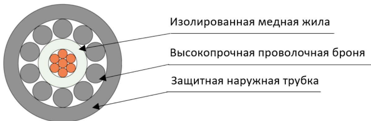
Рис. 1 Пример кабельной конструкции SlickLight
