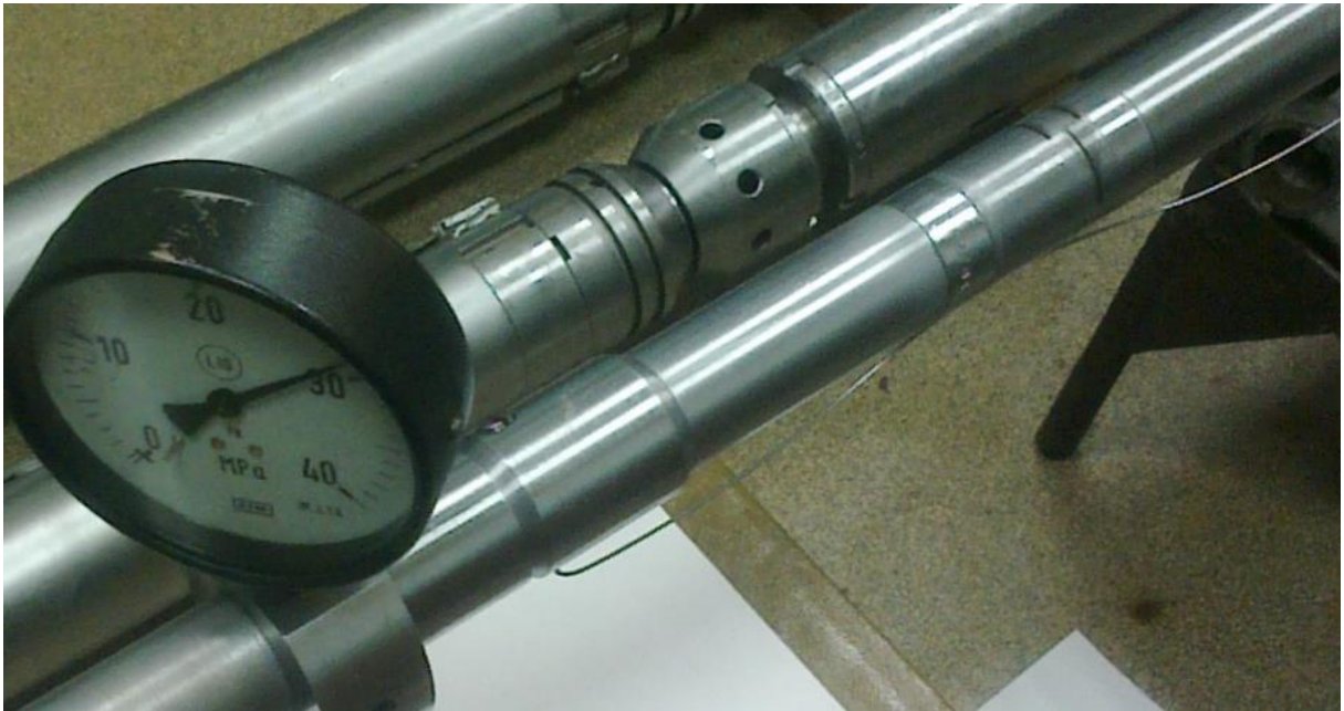
Рис.1. Измерение давление в контейнере при помощи импульсной трубки
