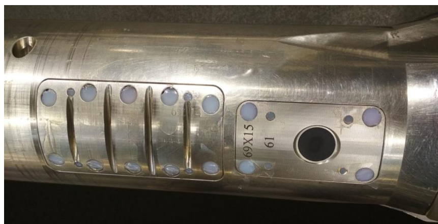
Рисунок 3. Общий вид акустического каверномера в составе аппаратуры LWD72.
