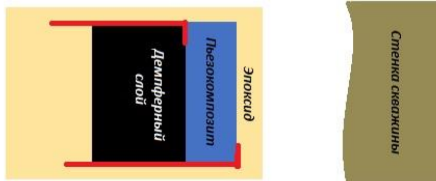
Рисунок 1. Конструкция акустического излучателя/приемника.
